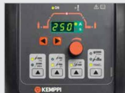
Panel de control de la MasterTig LT 250: selección de procesos TIG y MMA, ignición por HF o por Contacto, traba para el interruptor de la pistola, y selección por control remoto. Indicador de corriente, control de pre- y posgás, y temporizador para pendiente de corriente.
