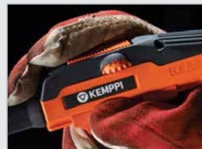
El control remoto RTC 10 se integra a las pistolas TIG TTC para regular fácilmente la corriente desde la pistola durante la soldadura.
