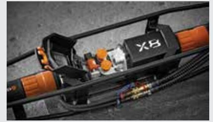
X8 SuperSnake cuenta con una versión de dos carretes para el potente mecanismo del alimentador de alambre X8 Wire Feeder con bloqueo firme. Los consumibles son intercambiables y están codificados por colores para que esté seguro de utilizar siempre la combinación correcta.
